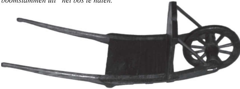
Houten kruiwagen met een groot wiel met metalen band en lange triemen of tremen.
