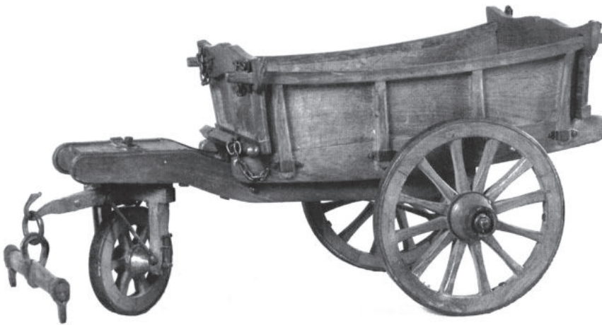
Boerderij driewielkar (schaal 1:7) met metalen banden; bak kan kippen en vervangen worden door een beerkuip
