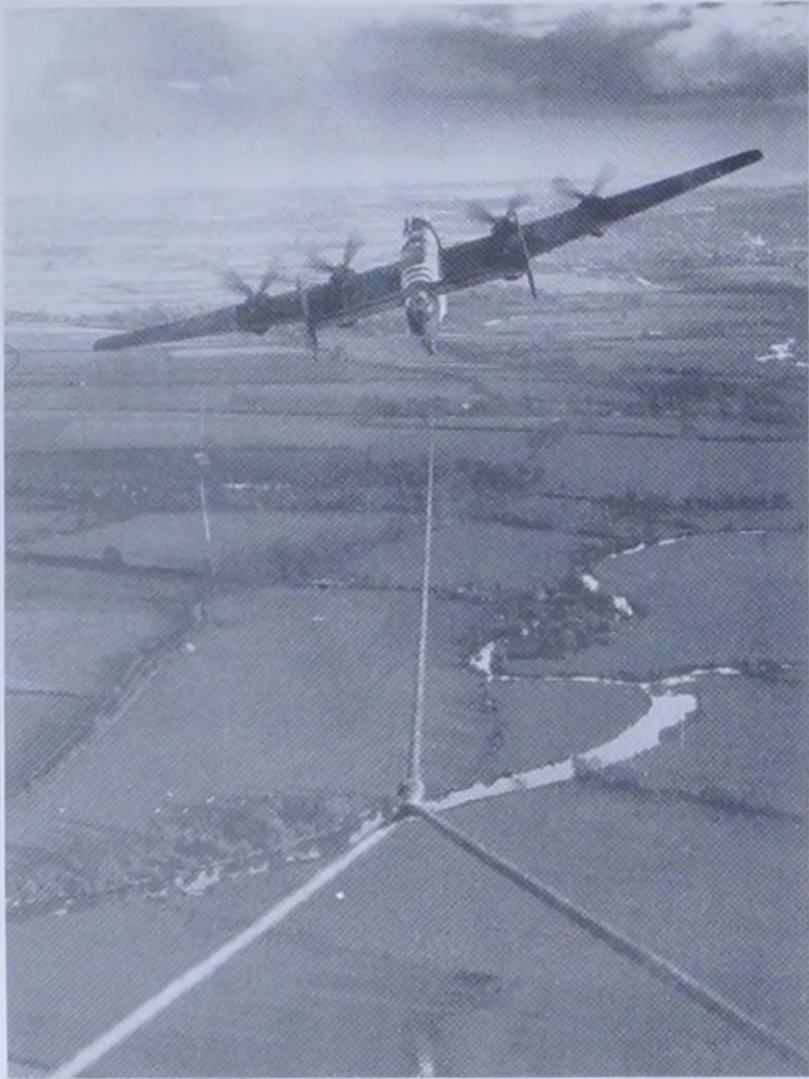
Halifax gefotografeerd vanuit de cockpit van de Hamilcar-zwever. De trekka- bel is nog goed zichtbaar.
